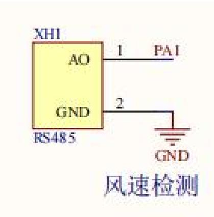
这款风速检测传感器遵循RS485通信标准工作。其内部的感应元件可捕捉外界风速变化，把风速这一物理量转化为电信号，再依托RS485通信协议，将处理后的风速电信号以数字形式稳定输出。
