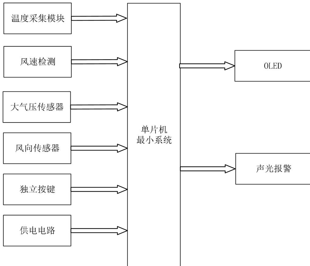
输入部分包含温度采集模块、风速检测模块、大气压传感器、风向传感器、独立按键以及供电电路。
