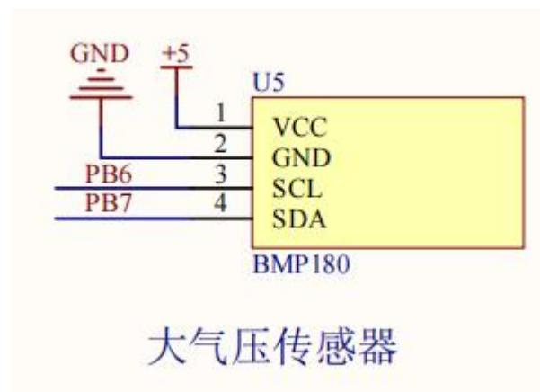
BMP180大气压强传感器基于压阻效应工作，其内部的敏感元件会随着外界大气压力变化而产生形变，进而导致电阻值改变，通过内部电路将电阻值变化转换为电信号，再经处理以数字信号形式输出大气压强数据。在本设计中，它的优势明显。它能精准覆盖设计中300 - 1100hPa的气压测量范围，测量精度高，可准确获取大气压强数值。同时，它功耗较低，适合装置长时间运行，能有效降低整体能耗。并且，它与单片机通信简便，能快速稳定地将大气压强数据传输给单片机，便于系统实时处理和显示数据。
