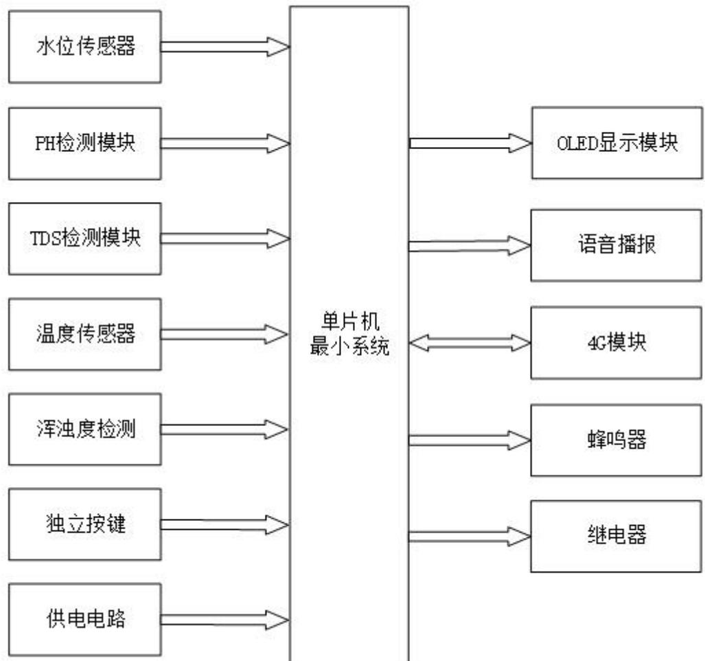
输入：水位传感器、PH检测模块、TDS检测模块、
